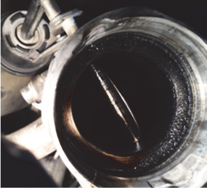
Fig. 4: tapa de la válvula de recirculación de gases de escape carbonizada
