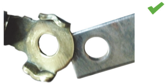
Fig. 2: conexión a la masa después de la limpieza: buen contacto
